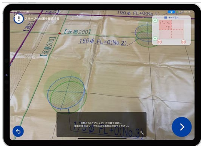
墨出し検査時の画面 (設計情報から仮想スリーブを表示)
