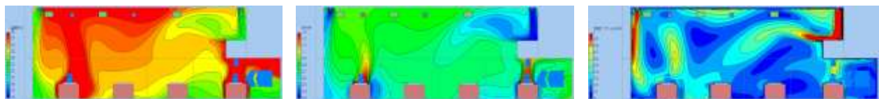
T-Flowによる室内空間の解析結果例 左：温度分布 中央：相対湿度分布 右：風速分布
