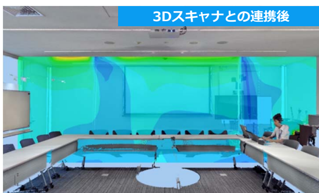
3Dレーザースキャナと気流シミュレーションの連携例
