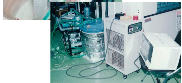
写真8 アイスオンコイルの氷蓄熱の実験装置
