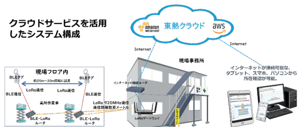
図11 高所作業車管理システム（mmMs：ムース）構成
