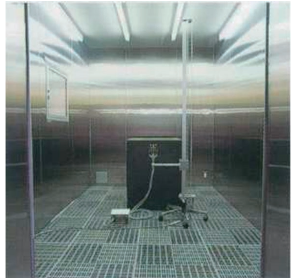
写真7 超恒温恒湿クリーンルームモックアップ
