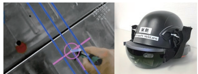
図12 MR技術を用いたインサート墨出し作業
