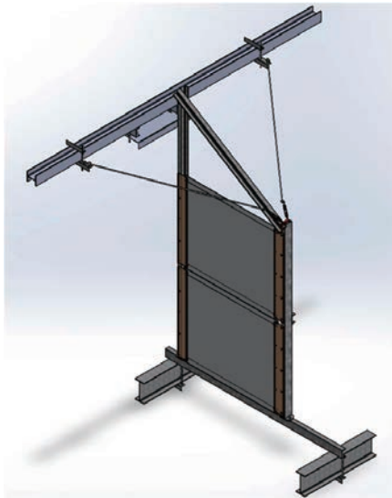
図8 通路遮蔽部のサンシェード取付図
